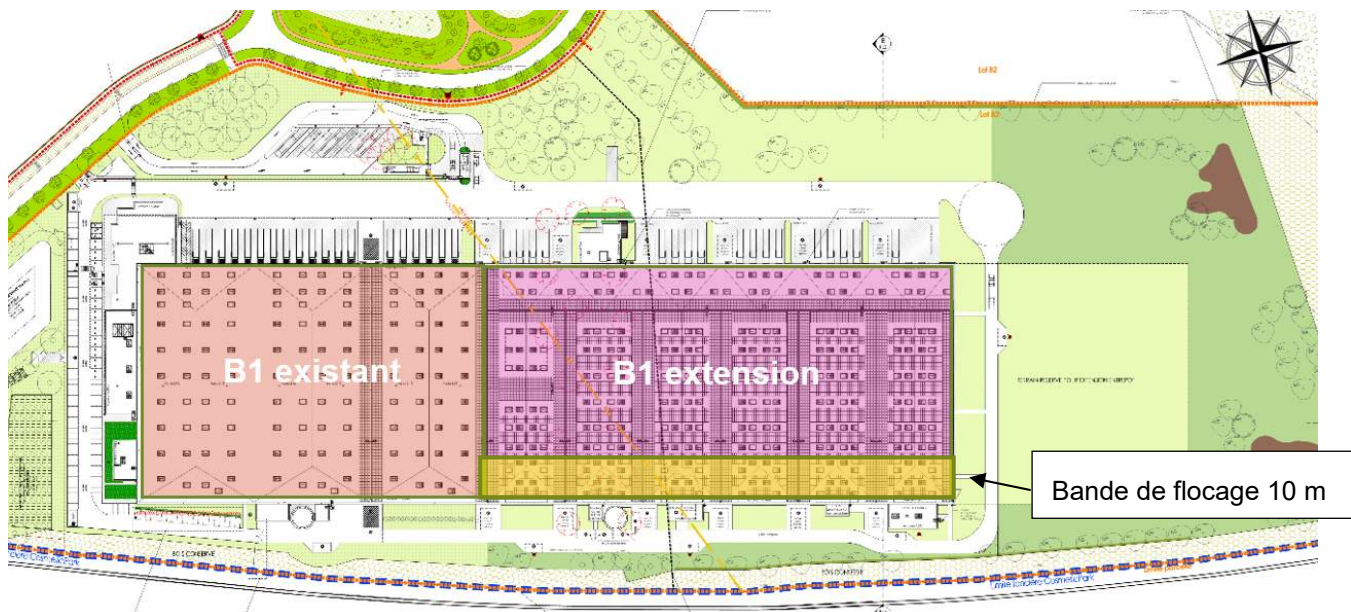
Flocage des cellules de l'extension du bâtiment B1
